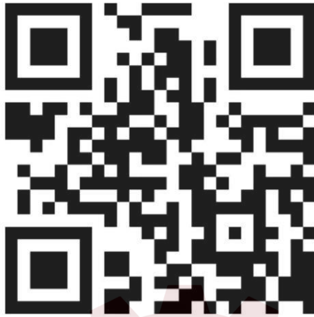
รูปที่ 2.30 ตัวอย่างบาร์โค้ด 2 มิติ (QR-Code)
